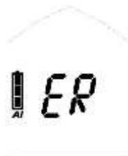
L'appareil transmet mais la fréquence n'est pas conforme
