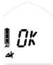
Lecture distance : l'appareil transmet et tous les paramètres de transmission sont conformes à la norme
