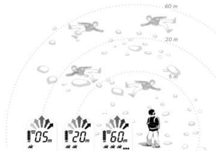
Le mode SCAN se termine automatiquement mais peut également être interrompu par une autre pression sur le bouton SCAN.
